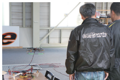
全天候屋内練習場 有線給電による 安全な飛行練習機 埼玉県ふじみ野市
